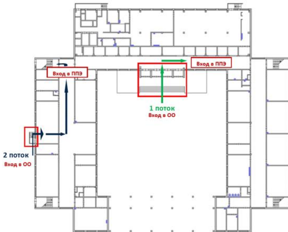
Рисунок 2. Пример организации входов в типовое здание ОО №2
